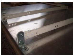
Figur 2 – skenorna/expansionsbeslagen monterade på den något nerskalade fästplattan.
