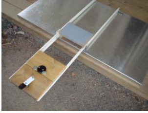
Figur 3 – Rotations- och låsningsanordning monterat på skenorna/expansionsbeslagen i utfällt läge.
