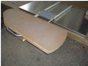
Figur 10 – Förenklad modell av ångpressen monterad på upphängningsanordningen i utfällt läge.
