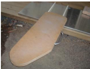
Figur 11 – Förenklad modell av ångpressen monterad på upphängningsanordningen i utfällt läge samt vriden 90 grader till vridstopp.
