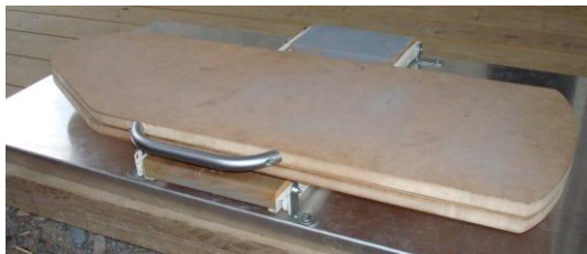
Figur 1 – Förenklad modell av ångpressen monterad på upphängningsanordningen i infällt läge.
