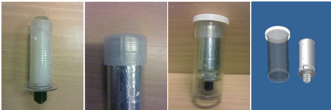
Figur 1: i första bilden visas hur clipset, med spår, sitter fast i botten och att vikten i röret är borta. Andra bilden visar att vikten i locket också är borta vilket bidrar till en minskad höjd. Bild nr tre visar att hela prototypen får plats i nuvarande behållare. Sista bilden är en bild på CAD-modellen som gjordes innan tillverkning av prototyp.
