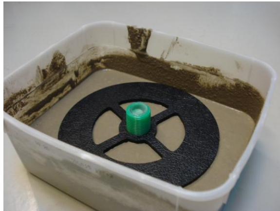
Figur 3. Test av prototypen i avjämningsmassa med densitet 2.0 g/cm 3
