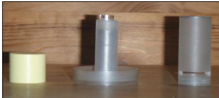
Figur 2 - Prototypens delar(lock, bottenplatta med plaströr, miljökammare)
