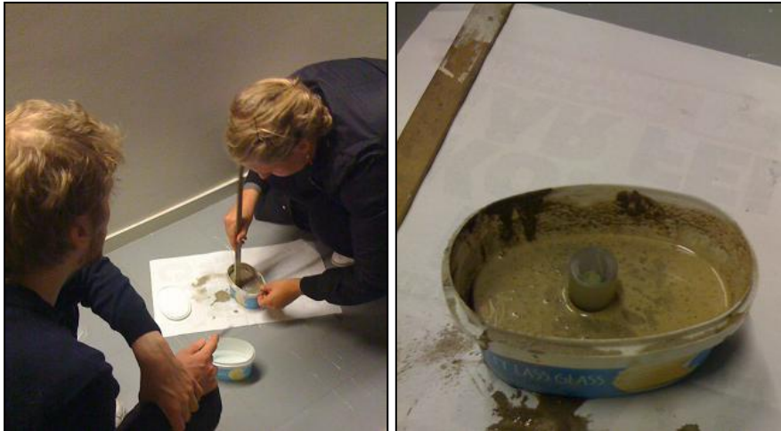
Figur 3 - Blandning av avjämningsmassa Figur 4 - Prototyp nedförd i avjämningsmassa vid funktionellt test
